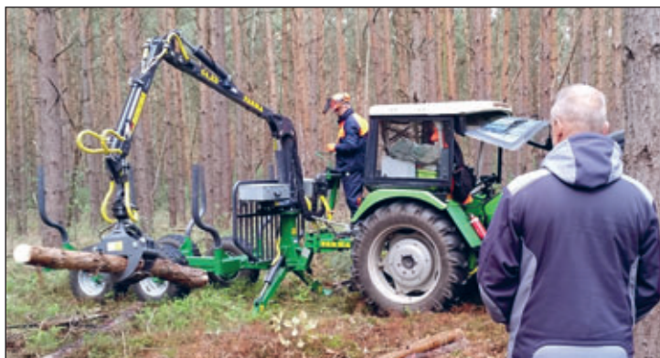
Holzrückung mit Traktor und Rückeanhänger im Privatwald (Foto: FBG Großenhainer Land w.V.)
